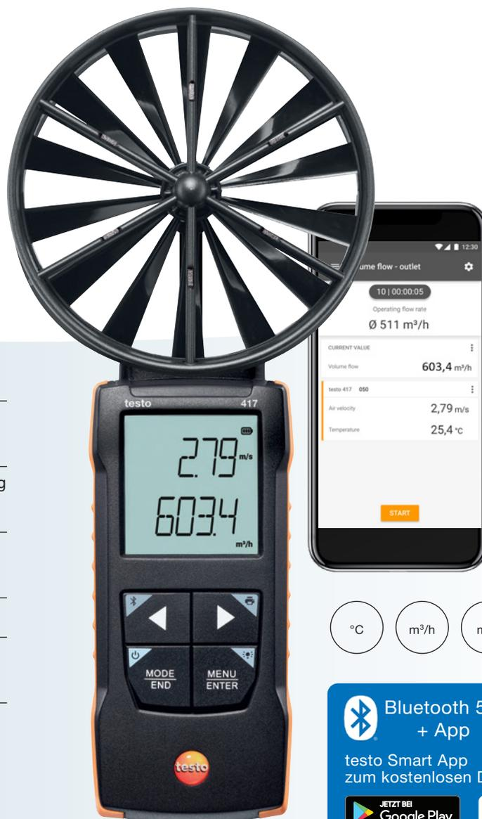
Das kompakte Flügelrad-Anemometer testo 417 wurde entwickelt, um Ihnen Messungen an Luftein- und -auslässen von **Klima- und Lüftungsanlagen** bestmöglich zu erleichtern. Das integrierte 100 mm-Flügelrad sorgt schnell für präzise Ergebnisse. Zeitliche und punktuelle Mittelwerte sowie der Volumenstrom werden automatisch im Gerät berechnet und auf dem Display angezeigt.
